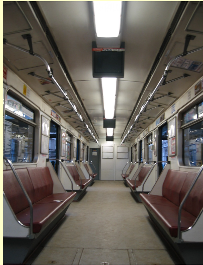
Вагон метрополітену серії 81-717, оснащений світлодіодними світильниками
