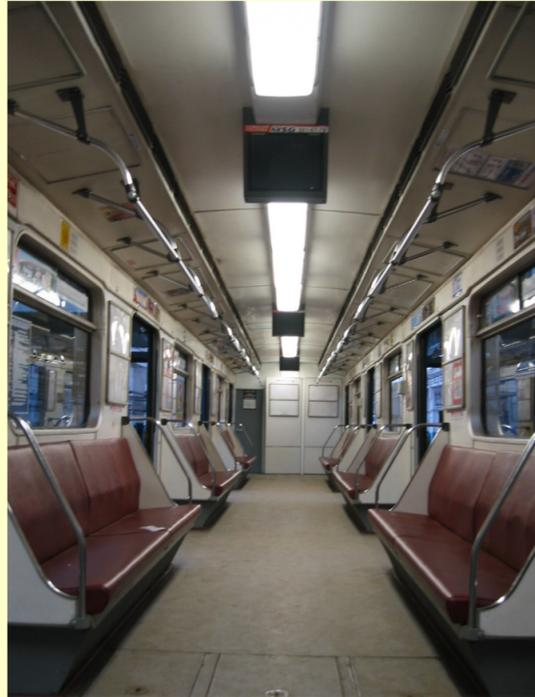
Вагон метрополитена серии 81-717, оснащенный светодиодными светильниками
