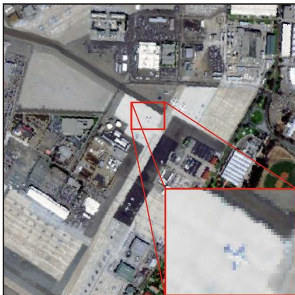
Рис. 3. Снимок, полученный аппаратурой Нурегіон спутника EO-1. Изображение представлено в системе RGB (R=28 канал ( \lambda=635 нм), G=19 канал ( \lambda=547 нм), B=10 канал ( \lambda=458 нм))
