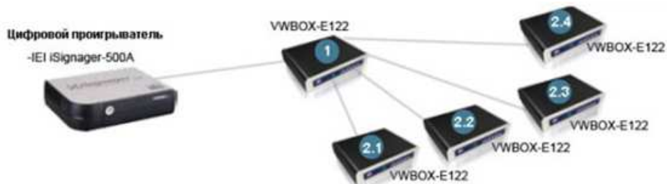
Рис. 3. Иерархическое подключение видеосплиттеров
