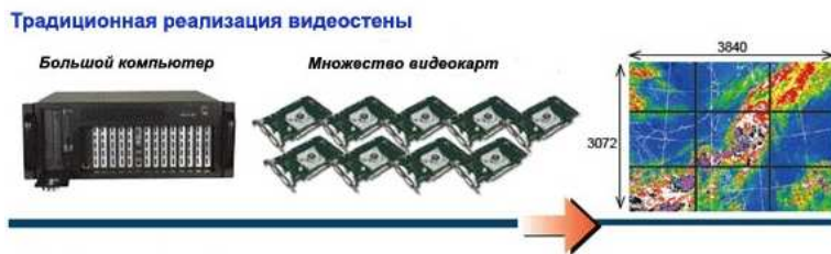
Рис. 1. Традиционное управление видеостеной
