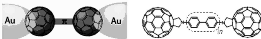
Рис. 9. Ліворуч – схема приєднання електропровідної молекули до золотих контактів через фулерени; праворуч – структурна формула однієї з таких електропровідних молекул «C 60 – поліфенілен – C 60 »
