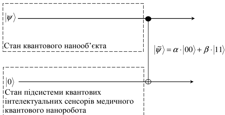
Рис. 5. Квантова логічна схема для моделювання на квантових комп'ютерах процесу вимірювання стану квантових нанооб'єктів підсистемами квантових інтелектуальних сенсорів медичних квантових нанороботів
