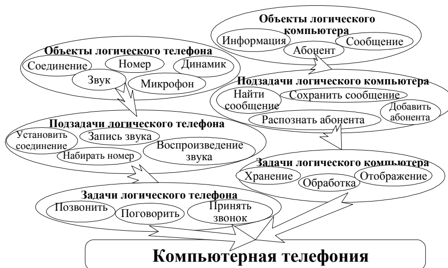
Рис. 4. Схема функциональной системы компьютерной телефонии с точки зрения логического компьютера и телефона
