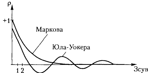
Рис. 4.25. Автокореляційна функція стаціонарного процесу
