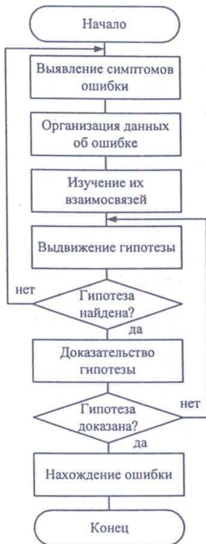
Рис. 10.3. Схема процесса отладки методом индукции
