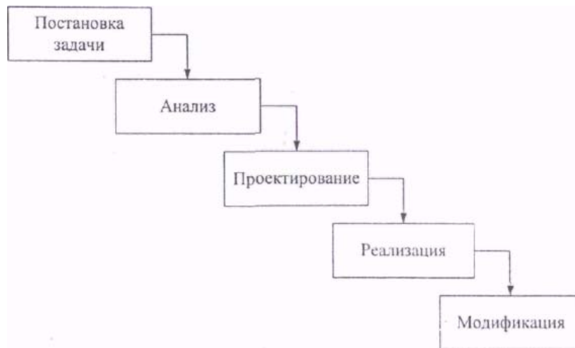
Рис. 1.10. Каскадная схема разработки программного обеспечения
