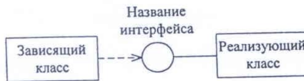
Рис. 7.15. Обозначение зависимости класса от интерфейса
