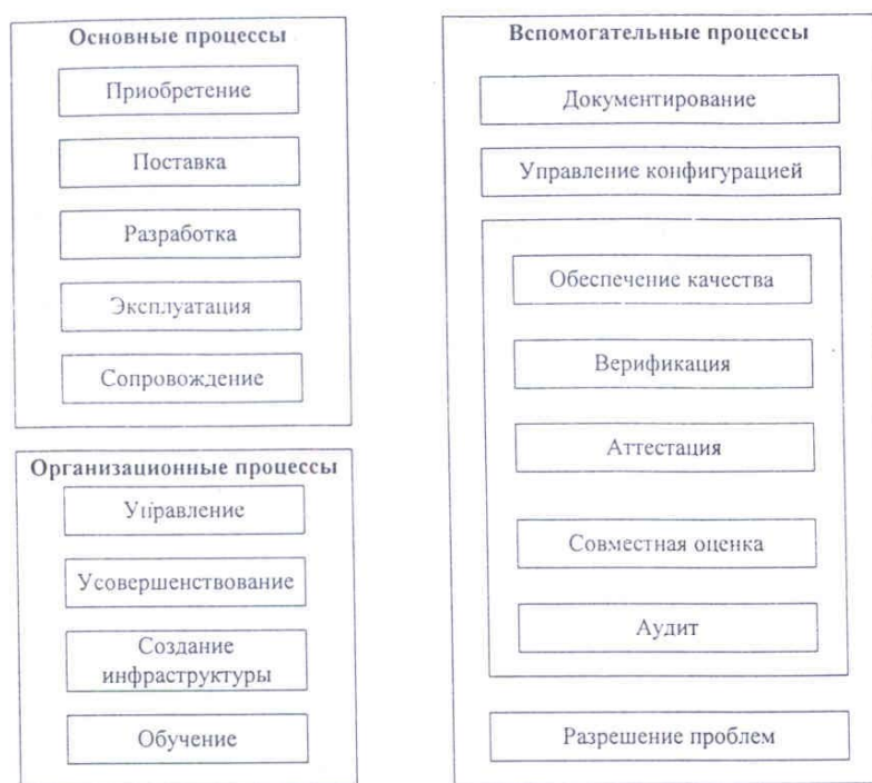
Рис. 1.9. Структура процессов жизненного цикла программного обеспечения
