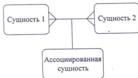
Рис. 4.31. Обозначение ассоциированной сущности в нотации Баркера
