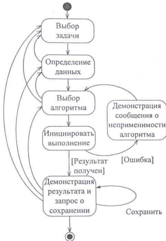
Рис. 8.13. Граф абстрактного диалога комбинированного типа
