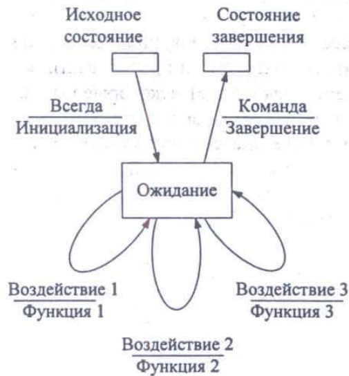
Рис. 4.5. Пример диаграммы переходов состояний программного обеспечения, активно взаимодействующего с окружающей средой
