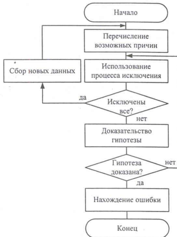
Рис. 10.4. Схема процесса отладки методом дедукции
