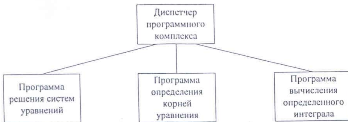
Рис. 5.1. Пример структурной схемы программного комплекса
