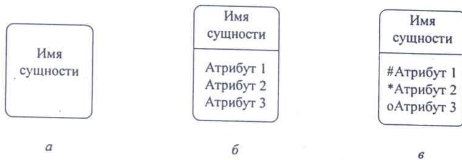
Рис. 4.27. Обозначения сущности в нотации Баркера: a – без атрибутов; б – с указанием атрибутов; в – с уточнением атрибутов и их типов (# – ключевой, * – обязательный, о – необязательный)
