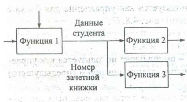
Рис. 4.9. Пример обозначения дуг при ветвлении
