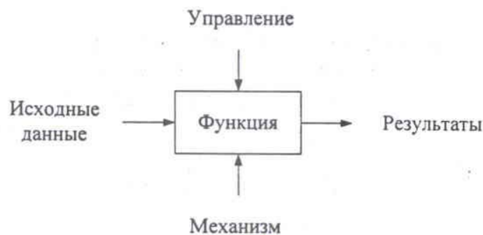
Рис. 4.7. Функциональный блок и интерфейсные дуги
