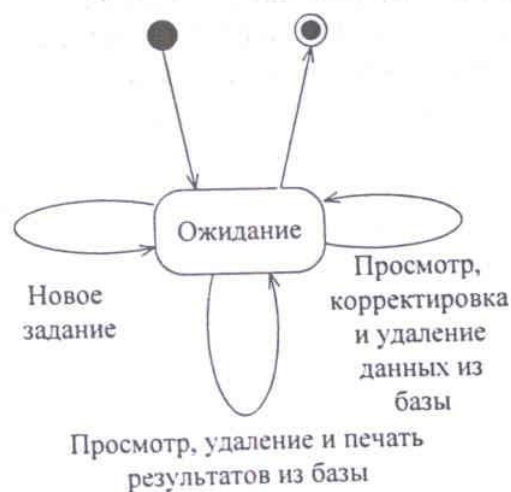
Рис. 8.11. Граф абстрактного диалога системы решения комбинаторно-оптимизационных задач
