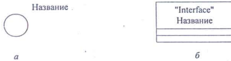
Рис. 7.13. Условные обозначения интерфейса в UML: a – специальное обозначение; б – с указанием стереотипа
