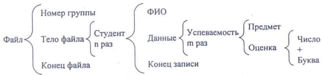
Рис. 4.26. Описание структуры файла «Электронная ведомость» в виде скобочной диаграммы Орра
