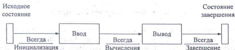
Рис. 4.4. Диаграмма переходов состояний программного обеспечения, активно не взаимодействующего с окружающей средой
