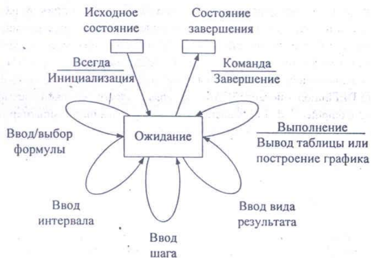
Рис. 4.6. Диаграмма переходов состояний программы построения графиков/таблиц функций
