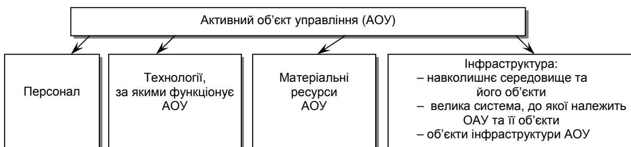
Рис. 1. Структурні та функціональні складові ОАУ, що виділені для проектування АСУ
