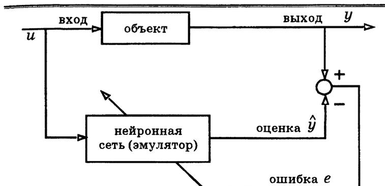
Рис. 4.3.5. Простая схема обучения для получения нейроэмулятора
