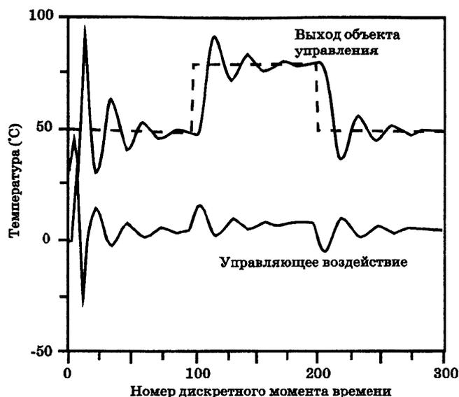
Рис. 3.4.3(a). Характеристика СНИД-контроллера для системы с уменьшенным значением коэффициента  $p_{n2}$
